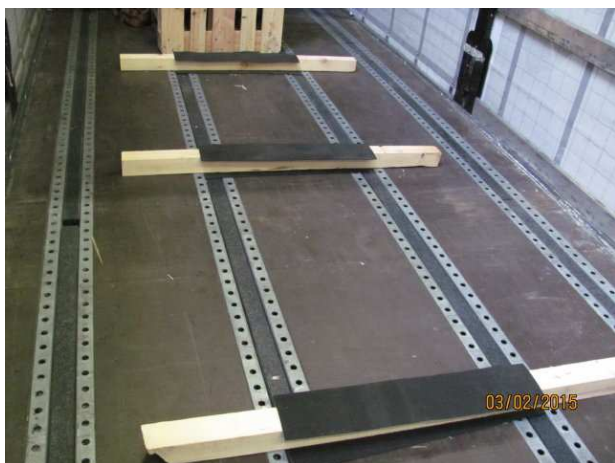
Europaletten und Rutschmatten vorbereiten!
