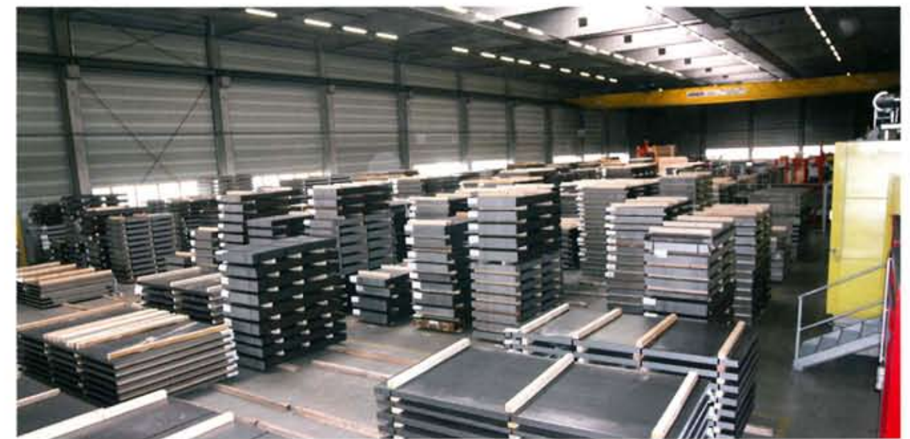
Dank moderner Anlagentechnik können warmgewalzte Stähle auf eine Länge von bis zu 18 Metern geschnitten werden.
